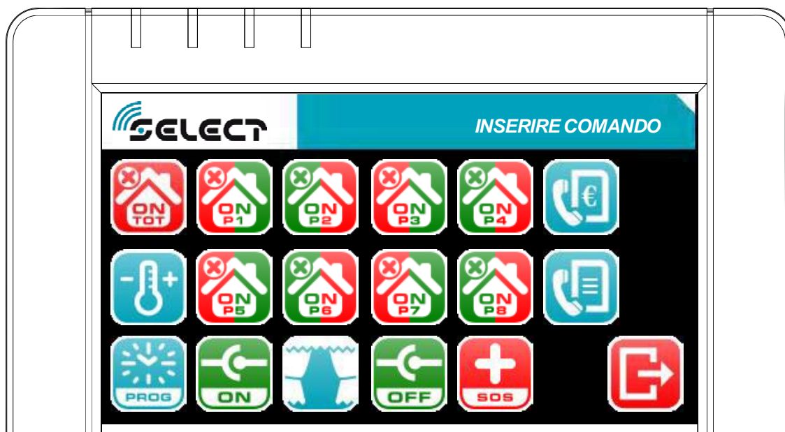
Fig 3.17- Lista funzioni associate al tasto FUN1 in caso di accesso dallo stato di OFF
