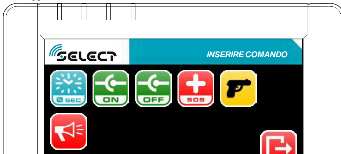
Fig 3.18- Funzioni associate al tasto FUN1 in caso di accesso dallo stato di attivazione PROGRAMMA1 - PROGRAMMA 8
